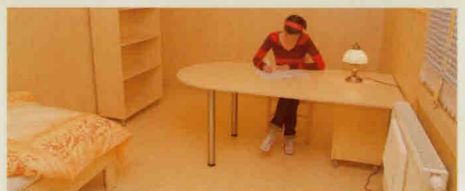
Bild 5: Der Versuchsraum mit Fichtenimitatausstattung (Spanplatte mit Fichtendekorüberzug)
